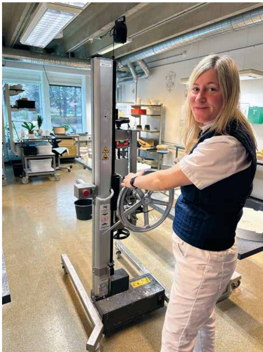
Gry Fager står ved Skipper, den kan løfte de meget tunge forme og har rat som på et skib. Drejer man på det hældes den overskydende porcelænsmasse ud.
